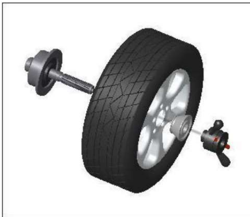
1 Montaż typu: koło-stożek-nakrętka (zalecane do felg stalowych)
